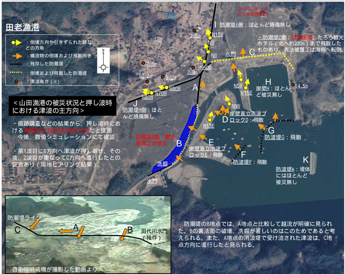
図1 田老漁港の被災状況
